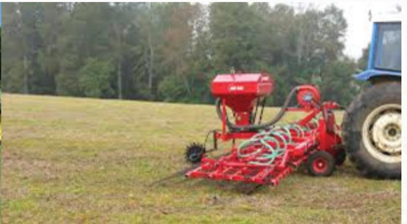
Dans les deux descriptions ci-dessus, l'idée est d'implanter la légumineuse en même temps que le désherbage mécanique des céréales en mars.
