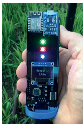
▲ Sonde tensiométrique © CSIRO
